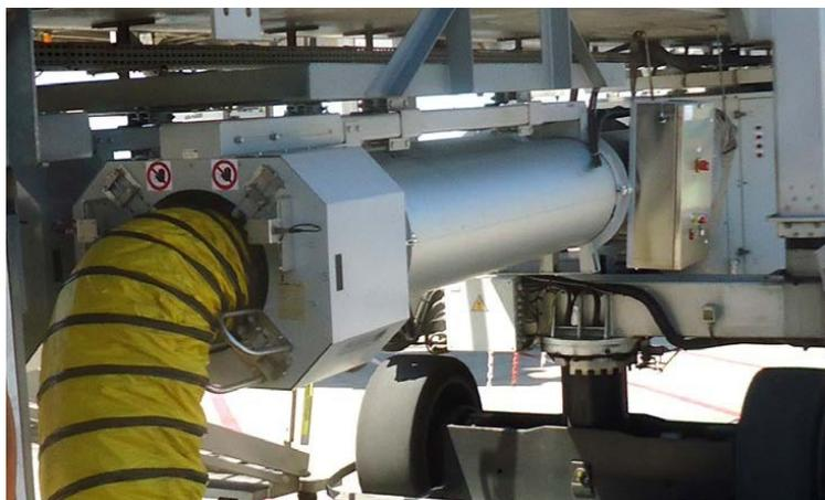
Ogni raccoglitubo motorizzato è fornito di una pulsantiera per l'estrazione e la ritrazione de tubo dell'aria oltre al telecomando fissato sul bocchettone di raccordo con il velivolo.
