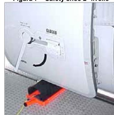
Figura 8 – Posizionamento corretto della safety shoe
