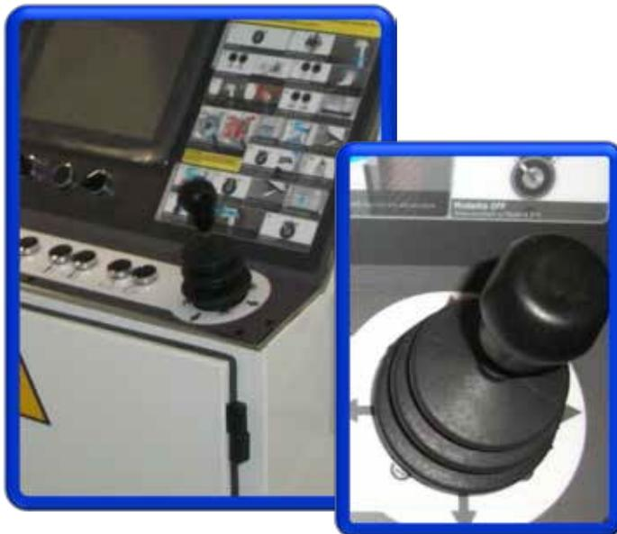
A seconda se il POINT TO GO si trovi attivo oppure inattivo, i variatori di velocità risponderanno in un modo oppure in un altro ai segnali che ad essi invia il comando di controllo.
